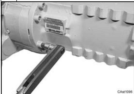
Svitare le viti di fissaggio per smontare la tromba trave.
