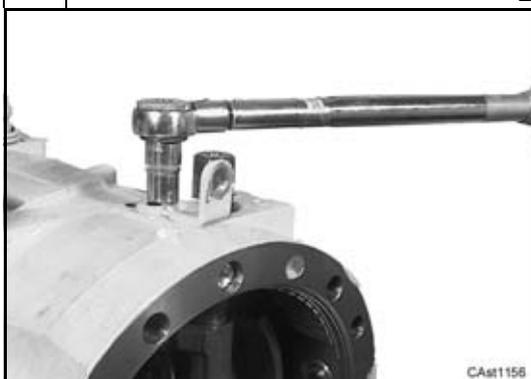
Avvitare e serrare le viti di fissaggio della staffa con chiave dinamometrica alla coppia prevista (Sez. C.8).
