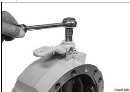
Svitare e rimuovere la vite di fissaggio leva all'estremità dell'albero.
