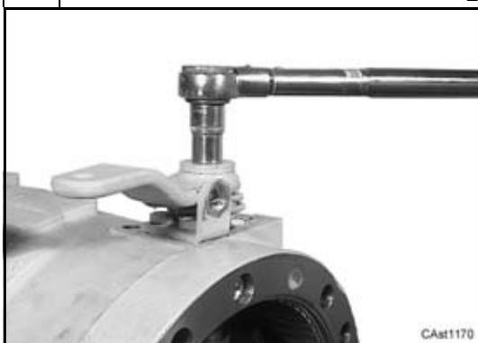
Serrare la vite di fissaggio della leva di comando con chiave dinamometrica alla coppia prevista (Sez. C.8).
