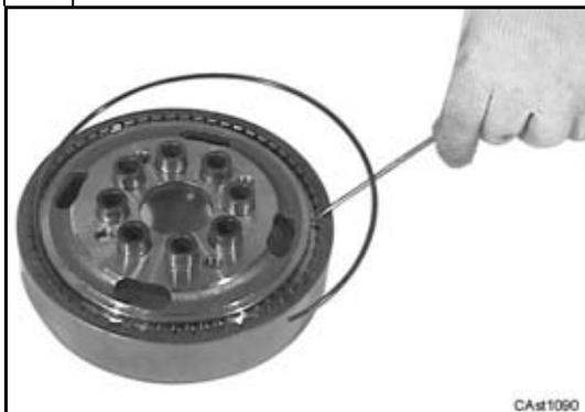
Rimuovere l'anello di arresto d'acciaio e separare il mozzo-fermo corona dalla corona epicicloidale.
