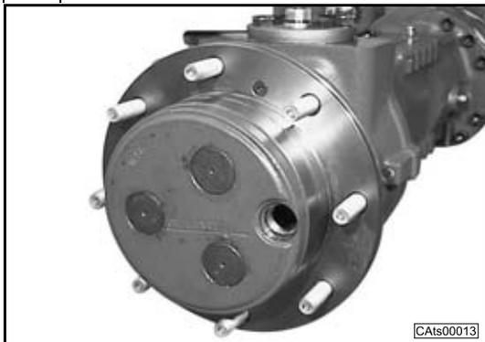
Ruotare gradualmente il mozzo fino a disporlo con il foro all'altezza dell'asse ruota in modo che la linea di livello dell'olio sia orizzontale. Verificare il livello dell'olio ed eventualmente rabboccare. Riavvitare il tappo con una chiave dinamometrica serrandolo alla coppia prevista (Sez. C.8)
