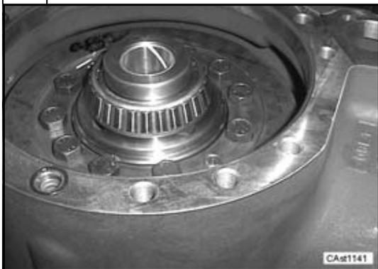
Prima della registrazione del precarico cuscinetti corona conica, prefissare i cilindri freno con due viti aggiuntive M14X120. Serrare a 79 Nm. A registrazione avvenuta, toglierle.
