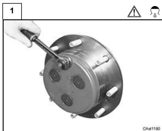
Prima di effettuare l'operazione di scarico dell'olio, posizionare il mozzo ruota con il tappo nel punto più alto e svitarlo di qualche giro per eliminare eventuale pressione interna, quindi rimuoverlo completamente.
