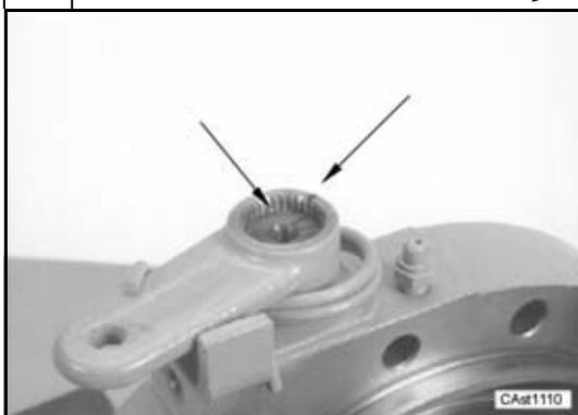
Tracciare un segno di riferimento indelebile sulla leva e sull'estremità dell'albero, per identificare il corretto allineamento dei due componenti e per distinguere il comando destro dal sinistro (per esempio: si possono praticare due segni sul destro ed un solo segno sul sinistro).
