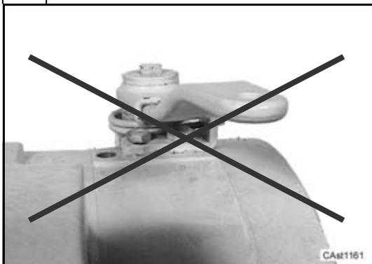
**Attenzione:** durante le fasi di manipolazione e di assemblaggio dei gruppi fare molta attenzione a non muovere la leva del comando freno. Questo potrebbe provocare lo scorretto posizionamento dei dischi e dei gruppi kit self-adjust e kit ritorno pistone con conseguente riduzione dell'efficacia del freno.
