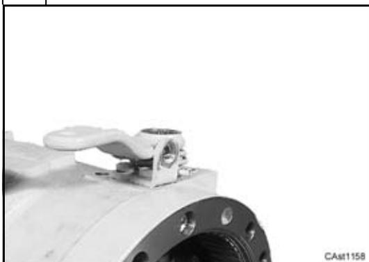
Inserire la leva di comando freno, rispettando i segni di riferimento praticati nella fase di smontaggio.
