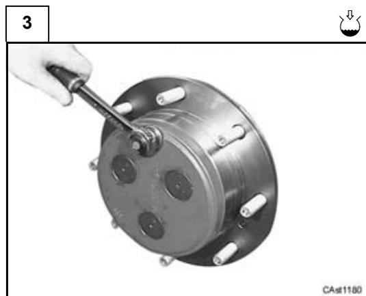
Prima di effettuare l'operazione di scarico o rabbocco dell'olio, posizionare il mozzo ruota con il tappo nel punto più alto e svitarlo di qualche giro in modo da eliminare l'eventuale pressione interna, quindi rimuoverlo completamente.
