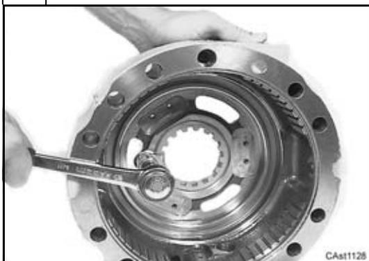
Svitare la vite di fissaggio del fermo ghiera.
